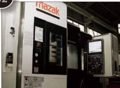
複合旋盤一台で、プランクから歯切りまでのワンストップ加工
